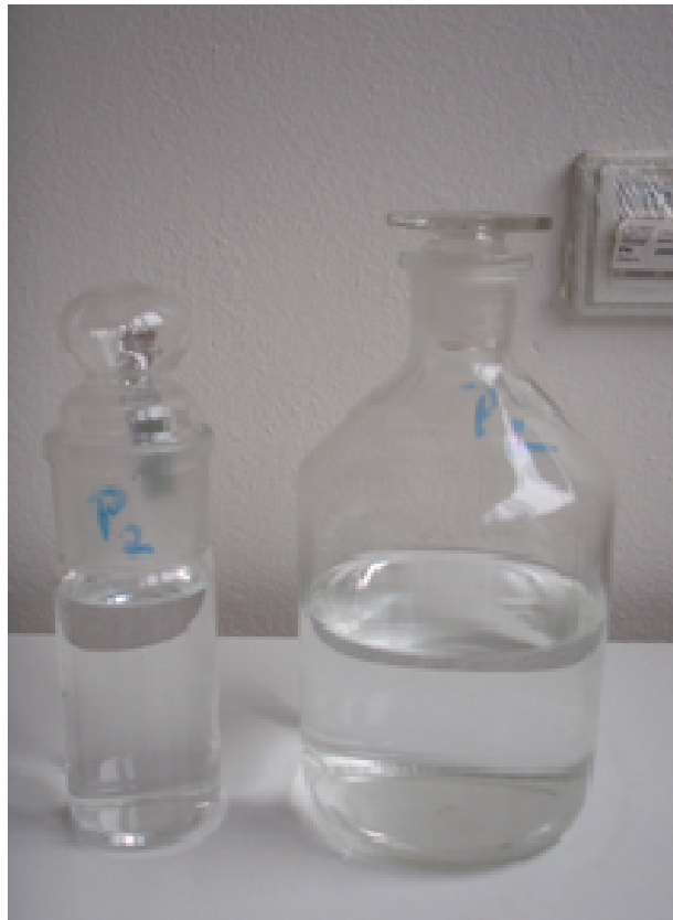
Obr. 2. Optická kyveta (vlevo) ve srovnání s klasickou vzorkovnicí, používanou na kultivační metodu
